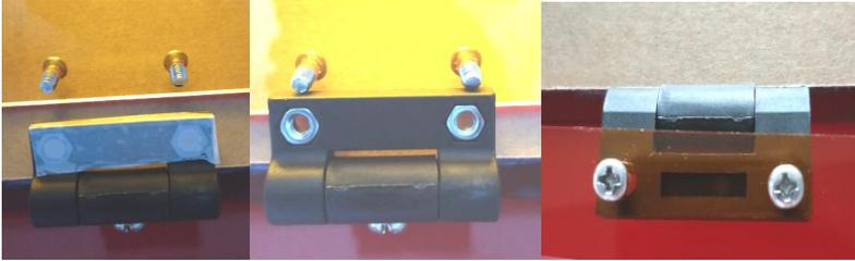
**安装示意图流程：**撕掉螺丝孔保护膜，将挡板从反面放入螺丝孔，用十字起子拧紧螺丝即可。
